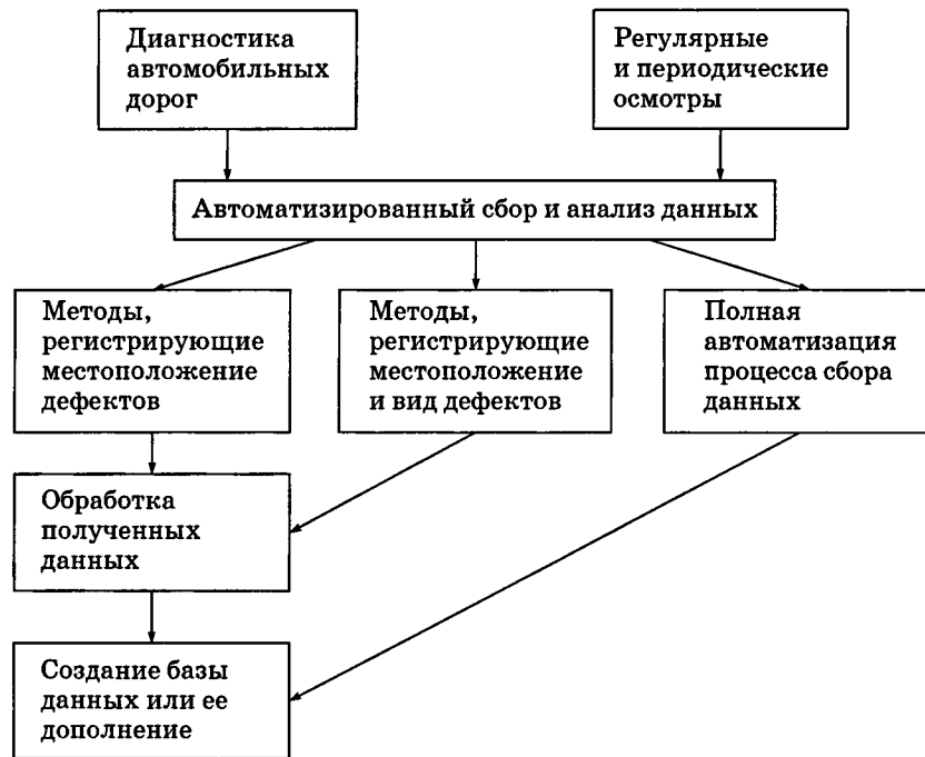
Рис. 6.29. Схема процесса регистрации дефектов и их дальнейшей обработки
