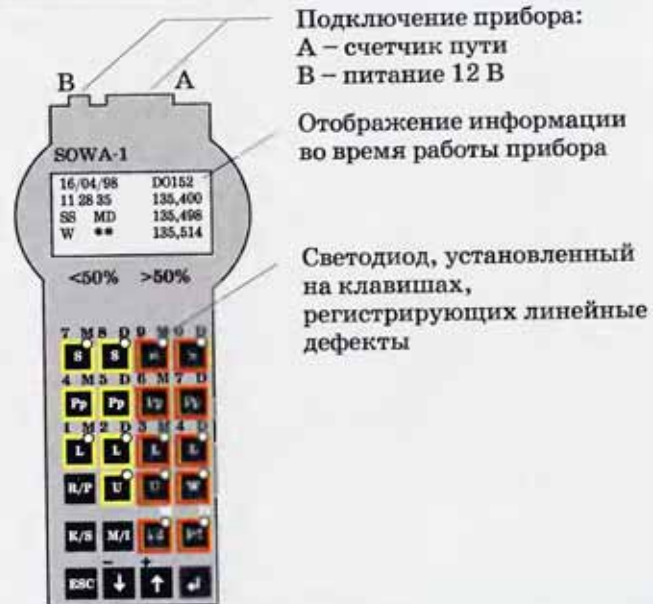
Рис. 6.30. Регистратор дефектов покрытия
