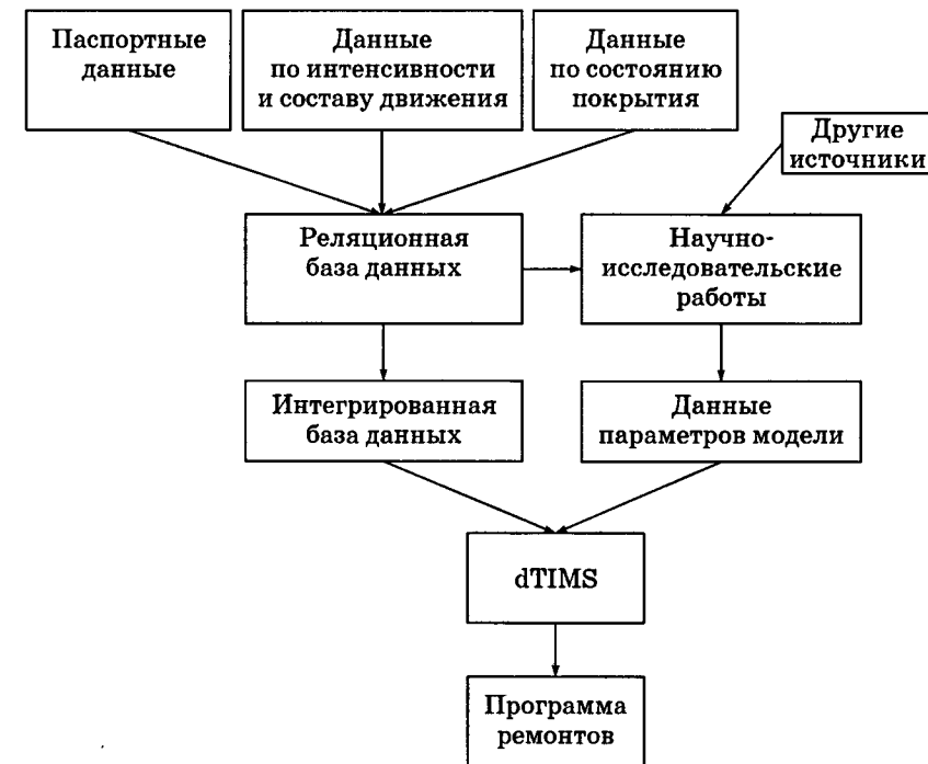
Рис. 10.3. Схема элементов системы dTIMS
