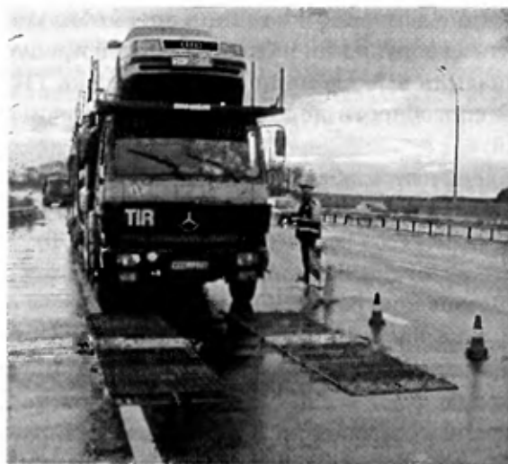
Рис. 7.14. Передвижной пост весогабаритного контроля
