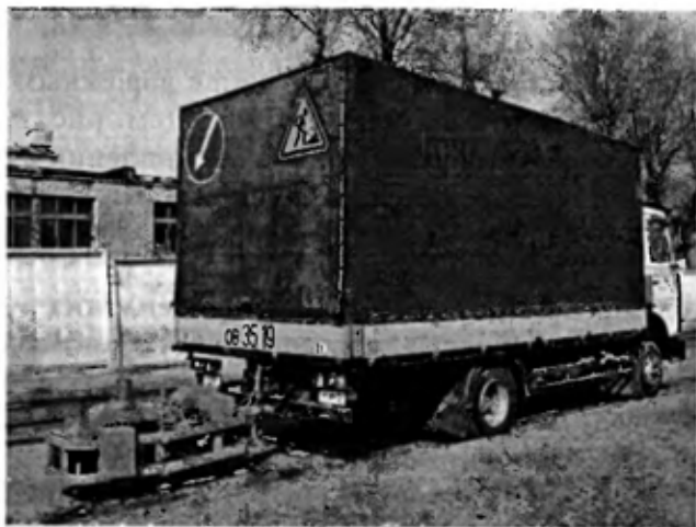
Рис. 4.12. Динамометрический прицеп ПКРС-2У
