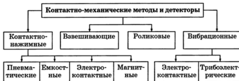
Рис. 7.1. Классификация контактно-механических методов и детекторов транспорта
