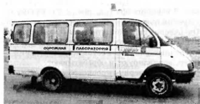
Рис. 5.1. Лаборатория визуального обследования дорог и определения геометрических параметров автомобильных дорог
