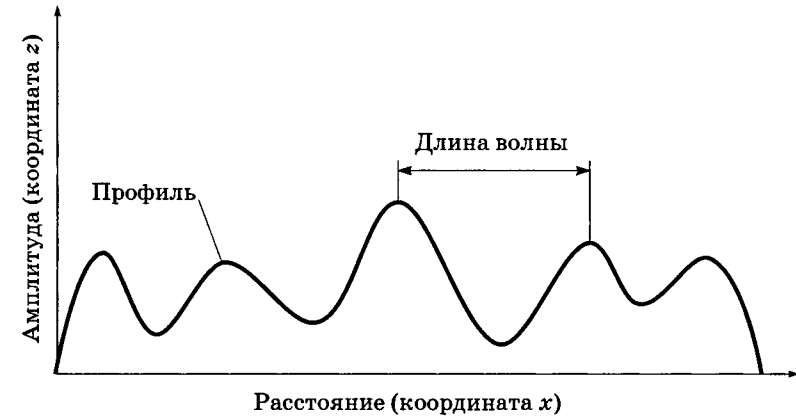
Рис. 2.3. Иллюстрация профиля поверхности покрытия, амплитуды и длины волны (амплитуда и длина волны с математической точки зрения изображены условно)
